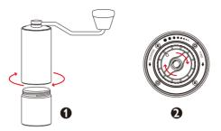
旋出粉碗,在主机身下端调整至所需的研磨粗细度
