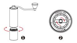
旋出粉碗,在主机身下端调整至所需的研磨粗细度
